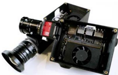
*Detektion und Identifikation von LKW anhand individueller Merkmale über smarte Kameras mit GPU.*
